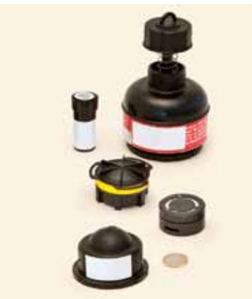
Appareils de mesure de la concentration en radon
